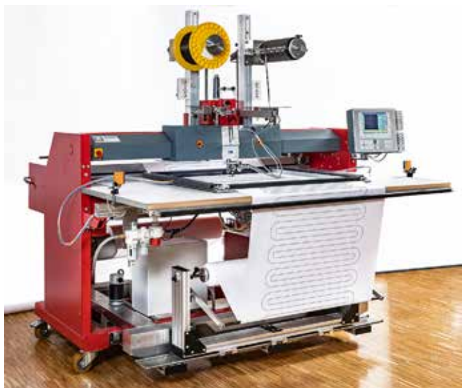
JGW 0100-650 (700) Max Stickfeldtiefe: 700 mm / Mitfahrender Rollenbock
